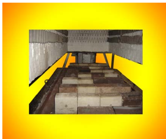
Forno elétrico contínuo de tratamento térmico de fitas de aço
